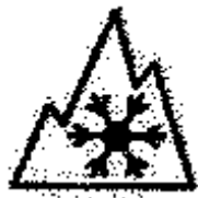
Рисунок 5.1. Маркировка, наносимая на зимнюю шину
